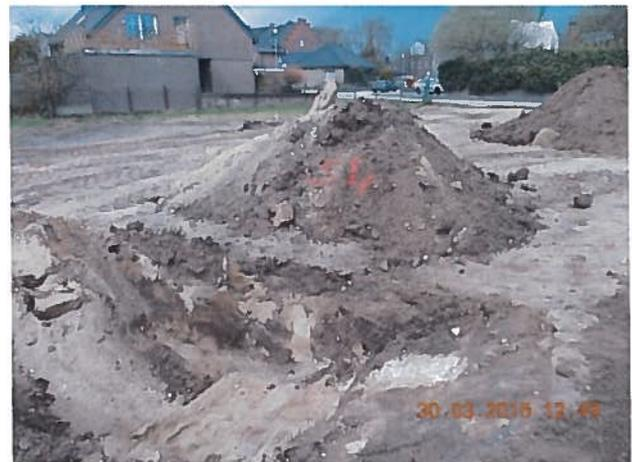
**Abbildung 29: Schurf 4/ GOK 9,66, Sohle 8,71, Boden, sandig, Asche, Schlacke, Ziegelreste**
