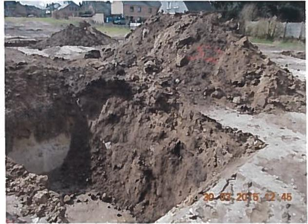
**Abbildung 27: Schurf 2 / GOK 9,72 m Sohle 7,86 m, Boden, sandig, kiesig, Asche, Schlacke, Ziegelreste**
